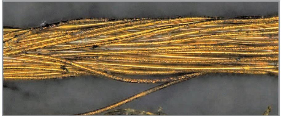
Mit einer Pilot-Schmelzspinnanlage ist die Empa in St.Gallen in der Lage, Fasern herzustellen, die aus zwei und mehr unterschiedlichen Polymeren bestehen. Dabei sind Faserquerschnitt und -profil variabel.
