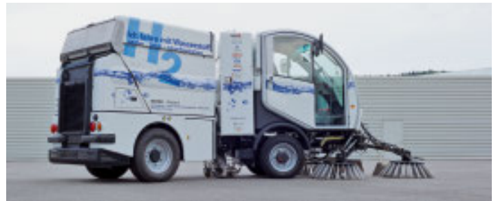
Der «hy.muve», ein wasserstoffbetriebenes Kehrfahrzeug, ist das Resultat einer Kooperation der Empa mit dem Fahrzeugbauer Bucher-Schörling. Eine Erfolgsgeschichte in 10 Schritten. 12
