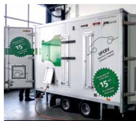
Donat Adams (vorn) und Patrick Haldi von der Berner Fachhochschule Technik und Informatik installieren Hochleistungselektronik und Batterien. Das gesamte Schnelladesystem findet in einem Autoanhänger Platz.
