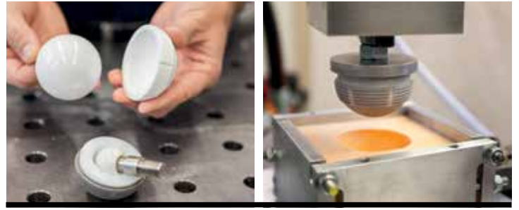
Links: Konstruktionschema einer Resurfacing-Prothese Mitte: Bauteile im Vergleich zu herkömmlicher Hüftprothese Rechts: Test-Verankerung in künstlicher Knochensubstanz
