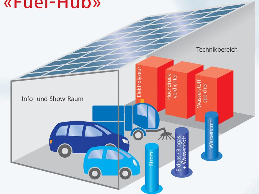
Der Elektrolyseur wandelt Solarstrom sowie Überschussenergie aus dem Netz in Wasserstoff um, der verdichtet und anschliessend gespeichert wird. An den Tanksäulen wird der Wasserstoff einerseits rein (für Brennstoffzellen-Fahrzeuge), andererseits als Gemisch mit Erd- bzw. Biogas (für Gas-Fahrzeuge) zur Verfügung gestellt.
